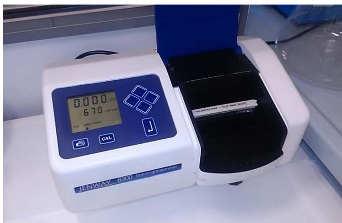
Figura 27. Spettrofotometro utilizzato per la lettura della densità ottica algale in cuvette da 10cm.
