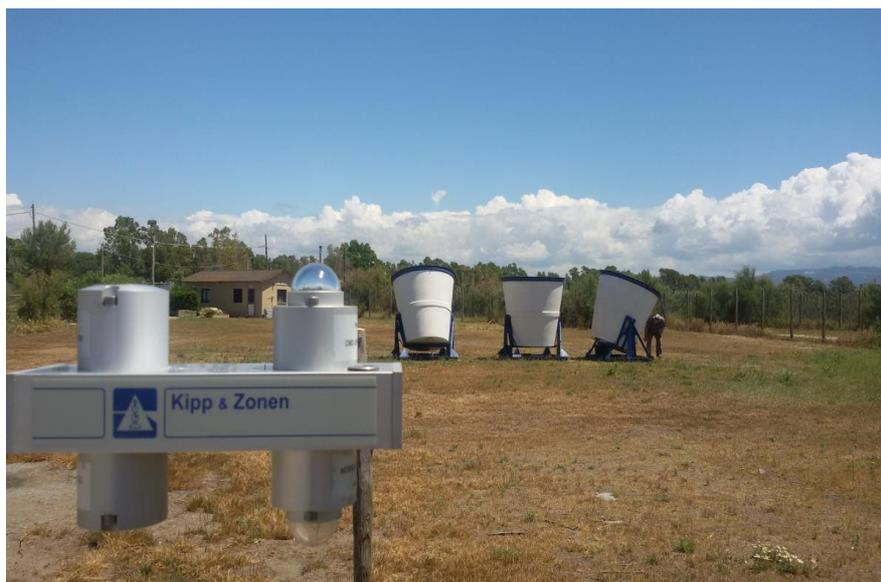
Figura 3. SODAR Doppler triassiale. In primo piano piranometri e pirgeometri
