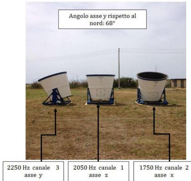
Figura 4. Antenne SODAR con la corrispondenza frequenza-canale- asse.
